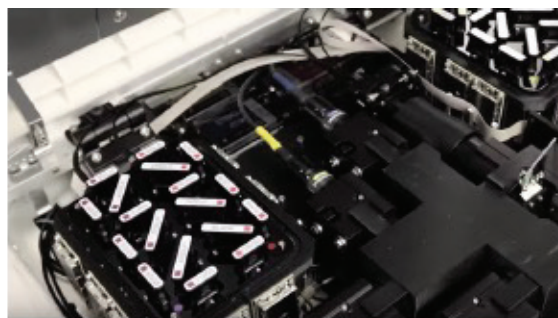
図 14. Attune NxT Flow Cytometer の蛍光フィルターはユーザーご自身で交換でき、光学ベンチに簡単に出し入れ可能
