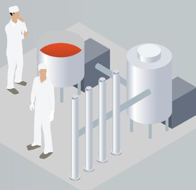
FBSは、特別に設計されたステンレススチール製パイプ経由でクリーンルームに移され、0.1 μmのフィルターで3回ろ過されることで生物学的な汚染物質が除去されます。
