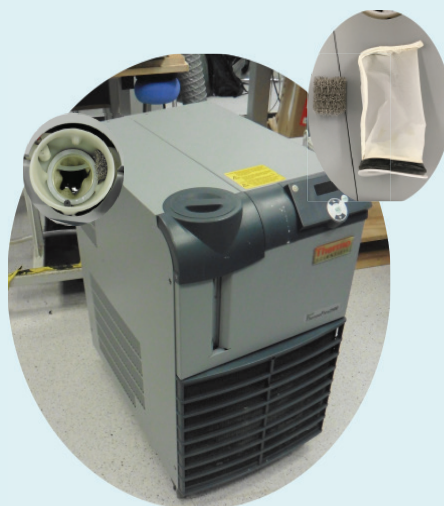
冷却水循環装置
