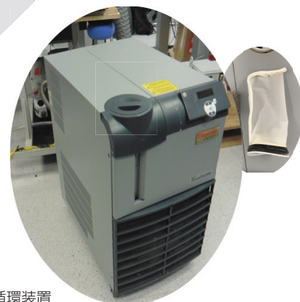
冷却水循環装置
