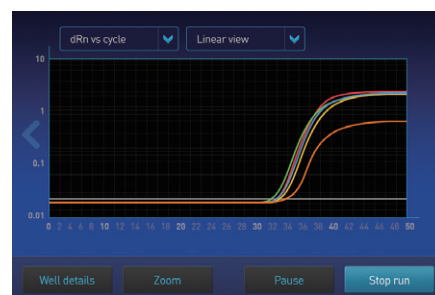
図4. インタラクティブタッチスクリーン画面上で、サイクル条件 (A) の編集やプレートレイアウトを簡単に確認することができます。また、ラン中にその増幅曲線 (B) やウェルごとの状況を確認することができます。
