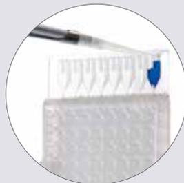
TaqMan Array Cards は、384 ウェルのカードにTaqMan プロローブとプライマーが固着(スポット)されており、8つのポートからサンプルを加えて遠心\* するだけで、分注作業が完了します。
