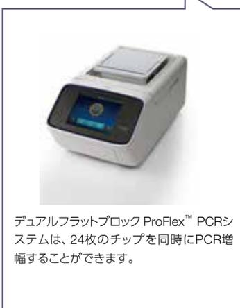
デュアルフラットブロック ProFlex™ PCRシステムは、24枚のチップを同時にPCR増幅することができます。
