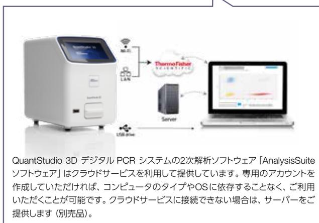
QuantStudio 3D デジタル PCR システムの2次解析ソフトウェア「AnalysisSuiteソフトウェア」はクラウドサービスを利用して提供しています。専用のアカウントを作成していただければ、コンピュータのタイプやOSに依存することなく、ご利用いただくことが可能です。クラウドサービスに接続できない場合は、サーバーをご提供します（別売品）。
