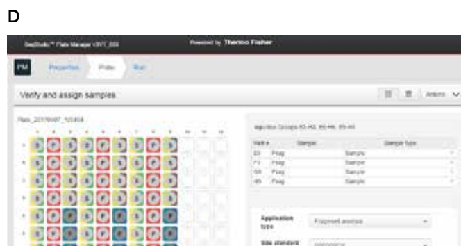
図1. SeqStudio Genetic Analyzer上のランのリアルタイムモニタリング (A) SeqStudioは各キャピラリの結果をリアルタイムで表示します。(B) インジェクションが完了すると品質チェック計算が実行され、結果が表示されます。トレースまたはQC値が良好でないインジェクションは、それらのサンプルの再インジェクションが可能で、必要に応じてインジェクションパラメーターの変更も可能です。(C) 遠隔モニターを行っているコンピューターにはランの進行状況が示されています。(D) PlateManager内でセットアップしたランを直接装置にアップロードできます。PlateManagerはカートリッジ内の汎用ポリマーを活用して、同一プレート上にシーケンシングおよびフラグメント解析のランを設定できます。
