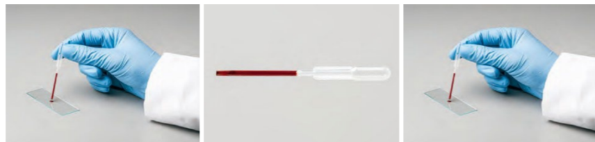
① 캐피러리 현상으로 흡입 ② 수평으로 눈금까지 정확하게 흡입 ③ 벌브를 눌러 분주
