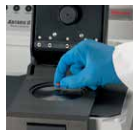
図1. ソフトジェル検出器を備えたAntaris II 近赤外アナライザー
