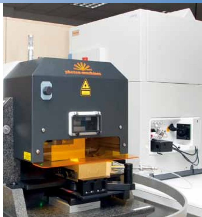
図1: iCAP Q ICP-MSに接続したPhoton Machines Analyte G2レーザーアブレーションシステム
