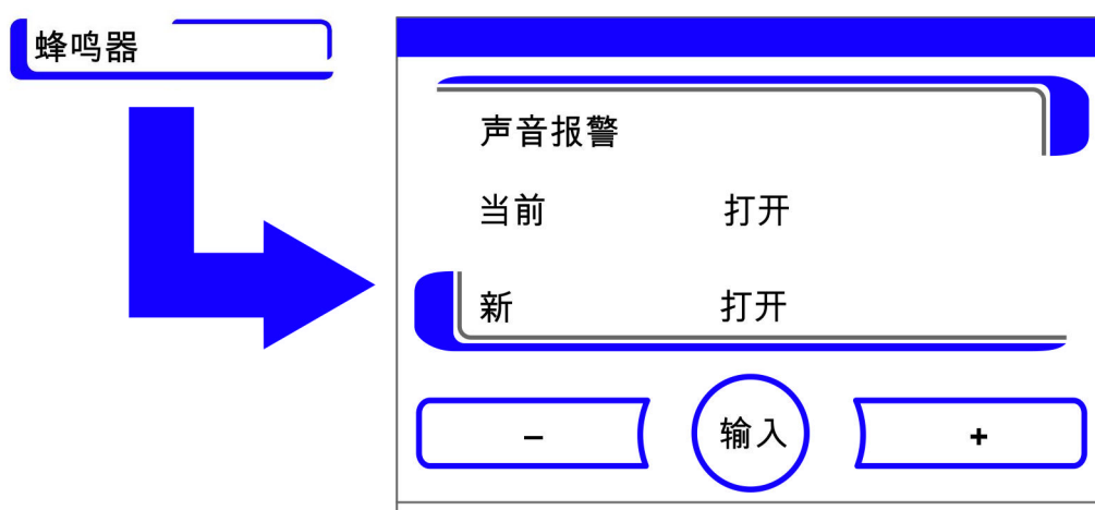
图 6-41. 设定报警继电器
