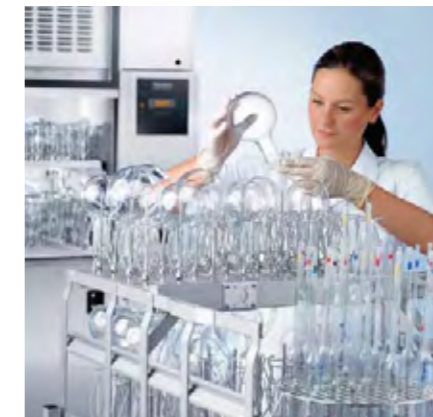
Großraumgerät mit 115 cm Baubreite Leistung/Charge: z. B. 232 Enghalsgläser, 232 Pipetten
