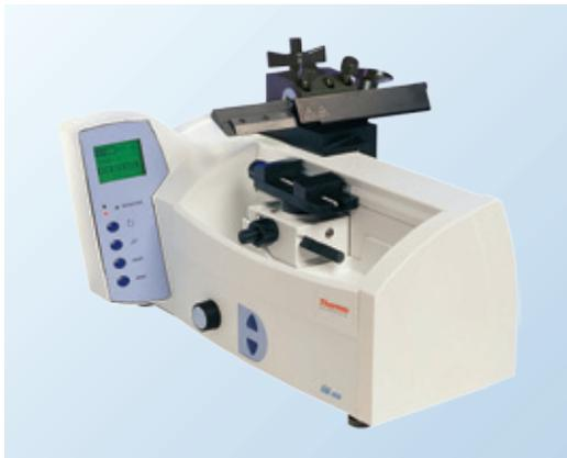
独自に開発されたステッピングモーターとリトラクション機能搭載のマイクローム
