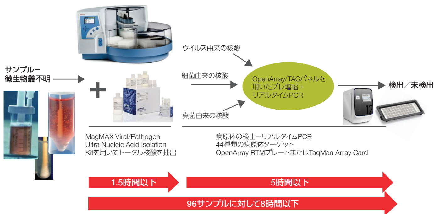
図2. 呼吸器病原体の検出ワークフロー MagMAX Viral/Pathogen Ultra Nucleic Acid Isolation Kitを用いてサンプルからトータル核酸を抽出し、OpenArray プレートまたは Applied Biosystems™ TaqMan™ Array Card (TAC) パネルを用いてプレ増幅およびリアルタイムPCR 解析を行うまでのワークフローを示したものです。最終結果として、44種類の病原体ターゲット (細菌、RNAウイルス、DNAウイルス、真菌) それぞれについて検出/未検出が表示される。
