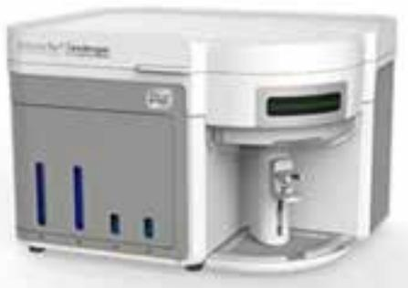
Applied Biosystems™ Attune™ NxT Flow Cytometerは、モジュールデザインによって最大4種のレーザーと14色のマルチプレックス解析を可能とする構成となっています。Attune NxT Flow Cytometerは、革新的なアコースティックフォーカシング技術を採用し、従来のサイトメーターの最大10倍のスピードで、レーザーを使用したマルチカラーフローサイトメトリー解析を実現します。
