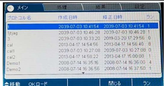
④ 測定を行う場合は START キー **START** を押します。本体よりプレートキャリアが排出されるので、プレートを載せて再度 **START** を押します。プロトコルの測定条件を利用して、測定が実行されます。
