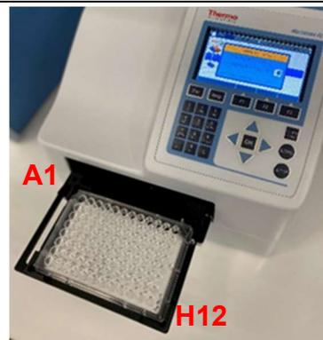
⑭ 測定するサンプルの数を確認されますが、変更せず **START** を押します。これで 96 ウェルプレートの全ウェルが測定対象となります。プレートキャリアが機器に入り、測定が開始されます。
