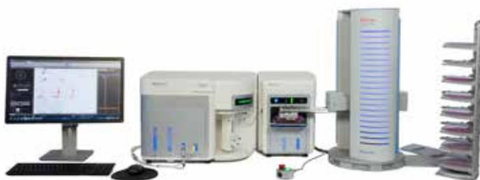
**自动化机械手臂** — 可与Thermo Scientific™ Orbitor™ RS微孔板移动机械臂和温度稳定的SmartStor™设备兼容，提高检测效率。
