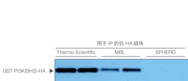
**图 35. Thermo Scientific™ Pierce™ 抗 HA 磁珠可实现更好的免疫沉淀。** 使用带有96 深孔板的 KingFisher Flex 纯化系统, 25μL 的 Pierce 抗 HA 磁珠, 抗 HA 标签磁珠 (MBL International Corp.) 和 SPHERO™ 免抗 HA 磁珠 (Spherotech Inc.) 分别从 50μg 大肠杆菌裂解液中免疫沉淀 GST-PI3K (SH2)-HA, 重复实验一次。用 0.1 M 甘氨酸, pH 2.0 洗脱捕获的蛋白质, 然后通过 SDS-PAGE 和 Western Blot 分析 HA 标记的蛋白质。
