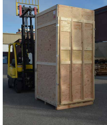
图 6. 用叉车将 500 L DynaDrive S.U.B. 竖起。
