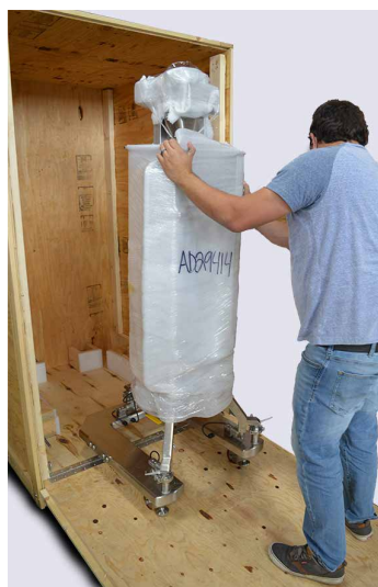
图 17. 小心地将 50 L 设备转下坡道。
