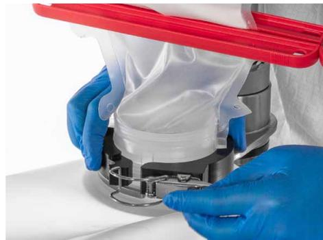
**Abbildung 6.6. Anbringen des Powdertainer am Pulveranschluss des BPC.**
