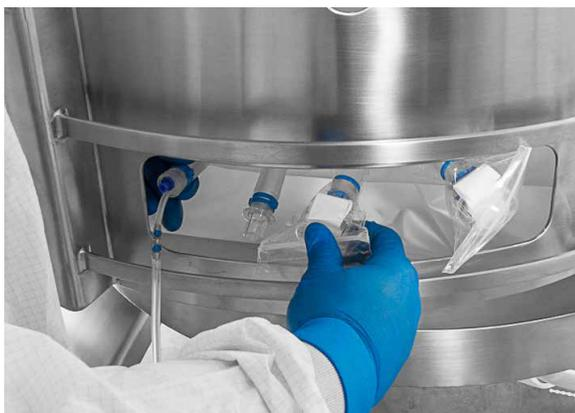
Abbildung 5.5. Position der Anschlussklemmen prüfen.
