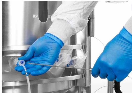
Abbildung 5.43. Einsetzen des Temperatursensors.
