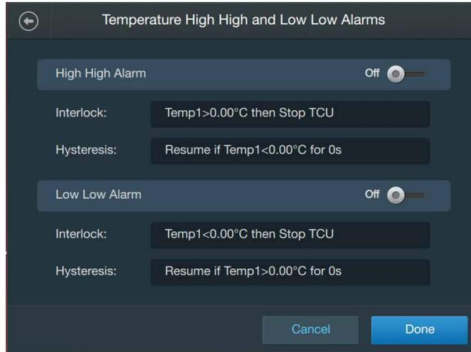
**Abbildung 3.42. Bildschirm „High High and Low Low Alarms“ (Zweiter Maximal- und Minimalwertalarm).**
