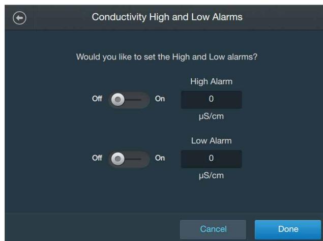
**Abbildung 3.37. Bildschirm „Conductivity High and Low Alarms“ (Maximal- und Minimalwertalarm für die Leitfähigkeit).**
