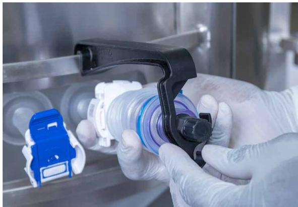
**Abbildung 5.48. Einsetzen der zusammengedrückten Sondeneinheit in die Sondenklemme.**
