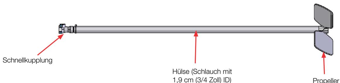
**Bitte beachten:** Die für das Mischen ohne Deckel erforderliche Lagernabe wird standardmäßig mit der Tankhardware geliefert. Beim 2.000 Liter-Propeller ist die Anschlussseite statt mit einer Schnellkupplung mit einer Tri-Clamp-Armatur versehen.
