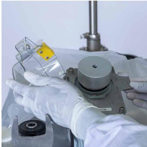
Abbildung 5.16. Schutzabdeckung entfernen.
