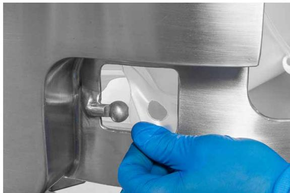
**Abbildung 5.8. Positionierlaschen des BPC an den Stiften ausrichten.**
