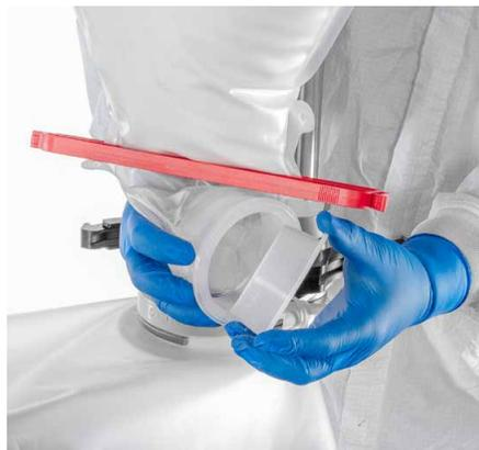
**Abbildung 6.4. Entfernen der Kappe vom Powdertainer.**
