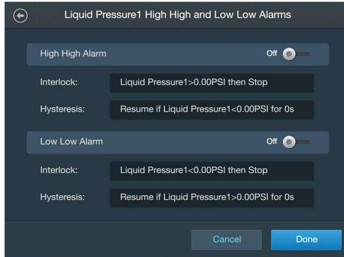
**Abbildung 3.51. Bildschirm „Liquid Pressure High High and Low Low Alarms“ (Zweiter Maximal- und Minimalwertalarm für den Flüssigkeitsdruck).**
