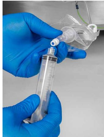
**Abbildung 6.10. Probenahmespritze einführen.**
