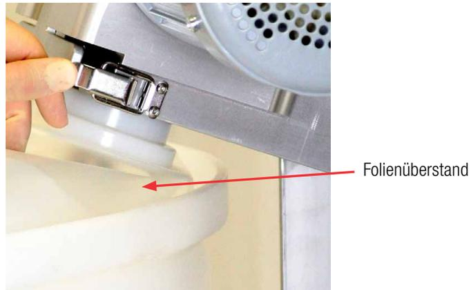
Abbildung 5.9. Ordnungsgemäß eingesetzter BPC.
