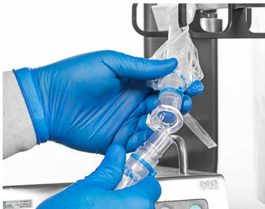
Abbildung 5.13. Schlauchanschluss.
