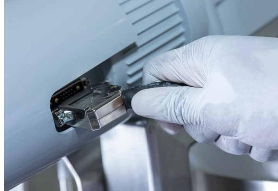
**Abbildung 3.7.** Motorsteuerungsanschluss.
