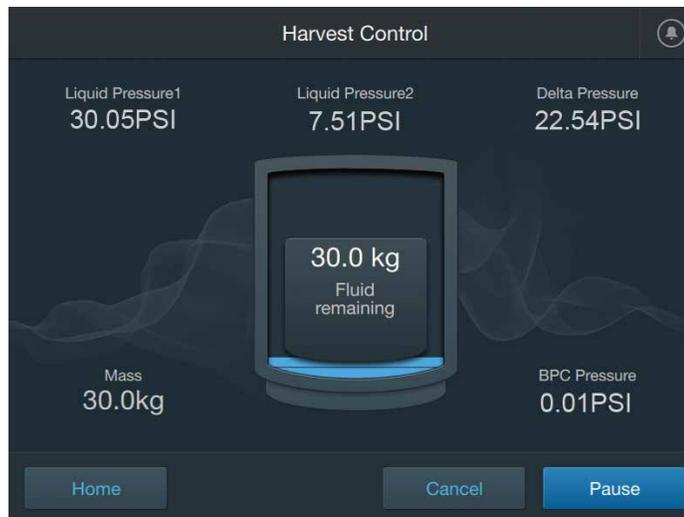
Abbildung 6.11. Bildschirm „Harvest Control“ (Entnahmesteuerung).
