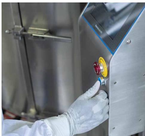
Abbildung 3.10. Blauen Taster „Power-On Reset“ (Einschalt-Not-Aus) drücken.
