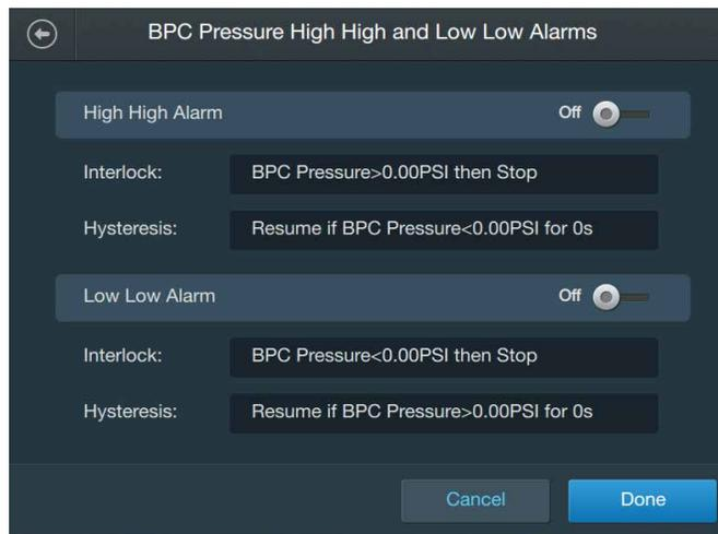
Abbildung 3.27. Bildschirm „BPC Pressure High High and Low Low Alarms“ (Zweiter Maximal- und Minimalwertalarm für den BPC-Druck).
