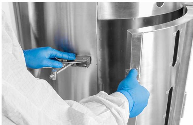
Abbildung 5.1. Öffnen der Tür eines 500 Liter-S.U.M.
