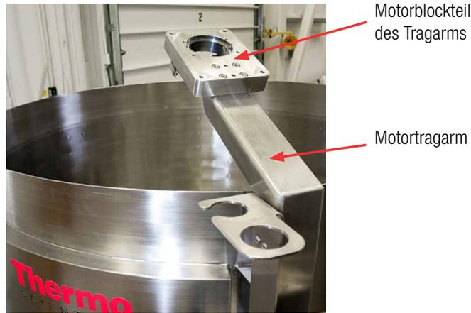
Abbildung 2.2. Motortragarm-Baugruppe des 2.000 Liter-S.U.M.
