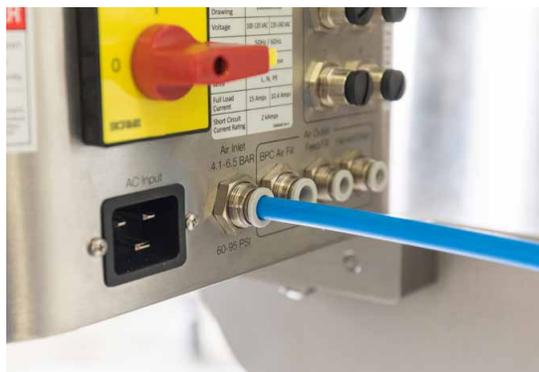
Abbildung 3.4. Angeschlossene Luftleitung an der Rückseite der Touchscreen-Konsole.
