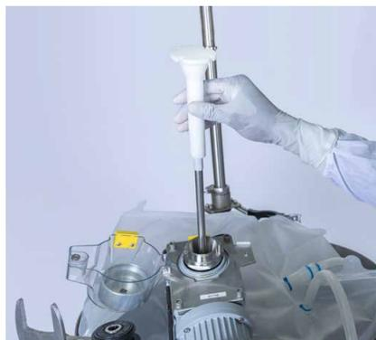
Abbildung 5.18. Einsetzen der Antriebswelle.
