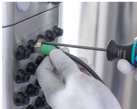
Abbildung 3.3. Pumpen an die Touchscreen-Konsole anschließen.
