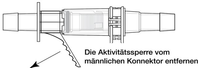
Abbildung 5.39. Entfernen der Aktivierungssperre.
