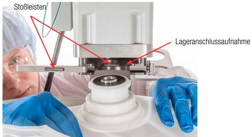
Abbildung 5.6. Lageranschluss in die Aufnahme einsetzen.
