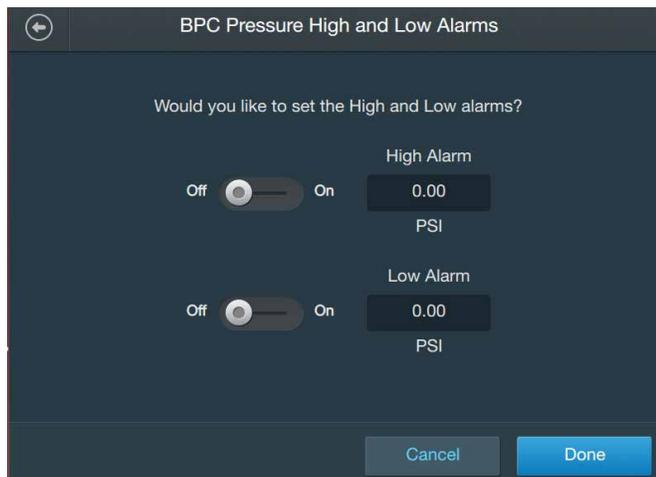
Abbildung 3.26. Bildschirm „BPC Pressure High and Low Alarms“ (Maximal- und Minimalwertalarm für den BPC-Druck).
