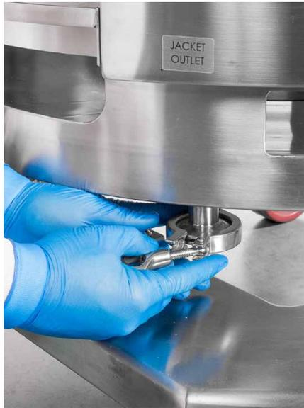
Abbildung 2.7. Entfernen der Tri-Clamp am Wassermantelauslass.
