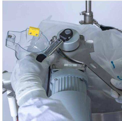
Abbildung 5.17. Kappe mit Schlüsseln entfernen.
