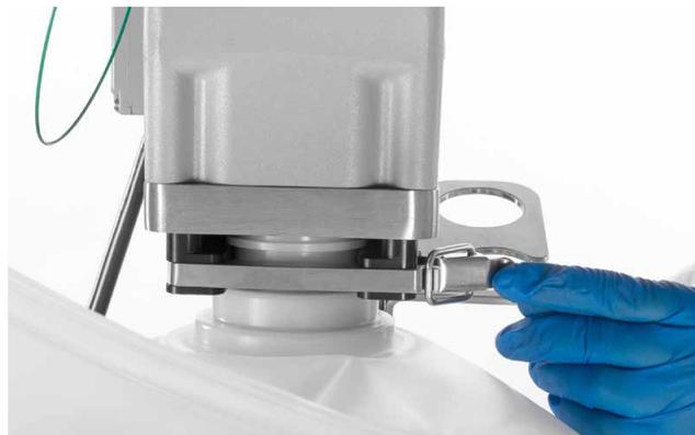
Abbildung 5.7. Lageranschlussschluss schließen und verriegeln.
