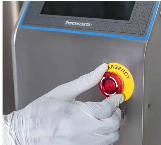
**Abbildung 3.6.** Zum Freigeben den Ring des Tasters „E-Stop“ (Not-Aus) im Uhrzeigersinn drehen.
