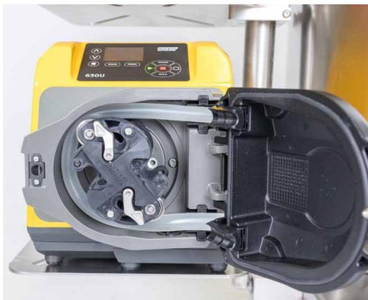
Abbildung 5.11. Ablaufleitung in der Peristaltikpumpe.
