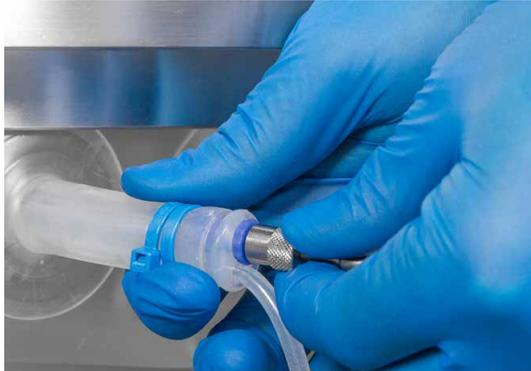
Abbildung 5.44. Temperatursensor drehen, damit er korrekt sitzt.
