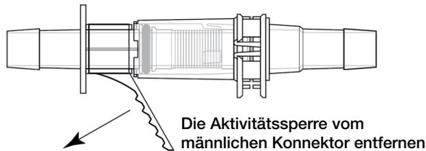
Abbildung 5.31. Entfernen der Aktivierungssperre.
