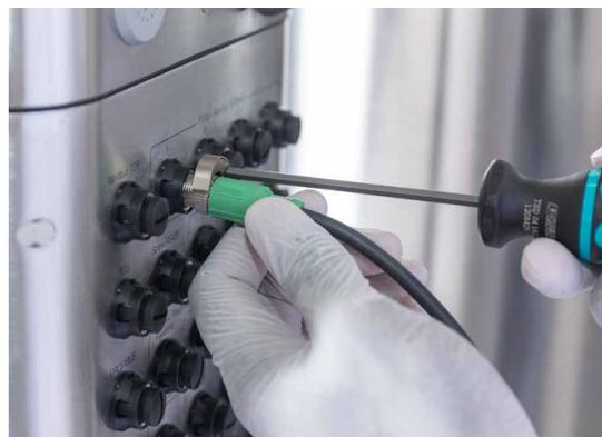
Abbildung 3.9. Kommunikationskabel an die Touchscreen-Konsole anschließen.
