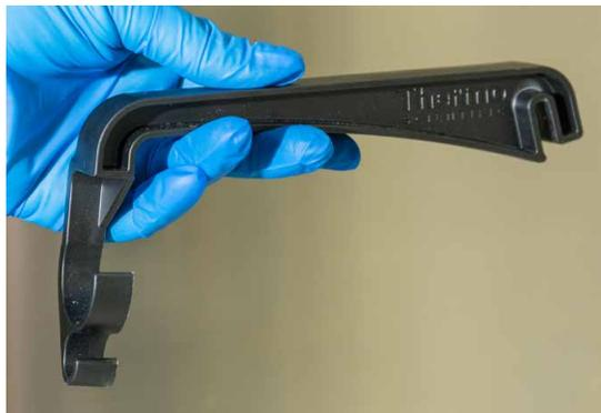
Abbildung 1.9. Kunststoff-Sondenklemme.
