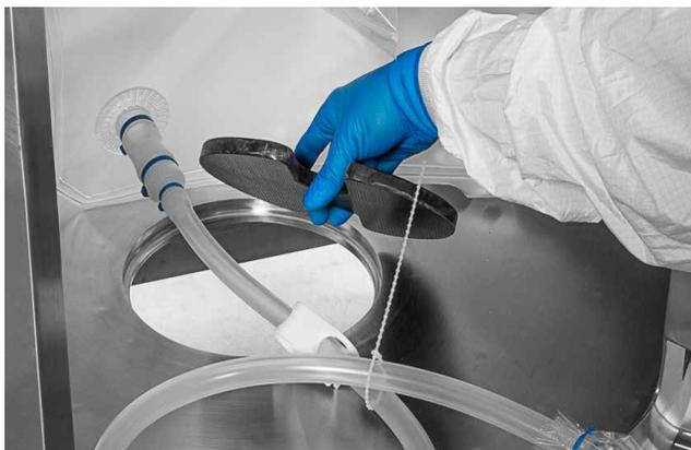
Abbildung 5.4. Ablaufleitung durch den Tank führen.
