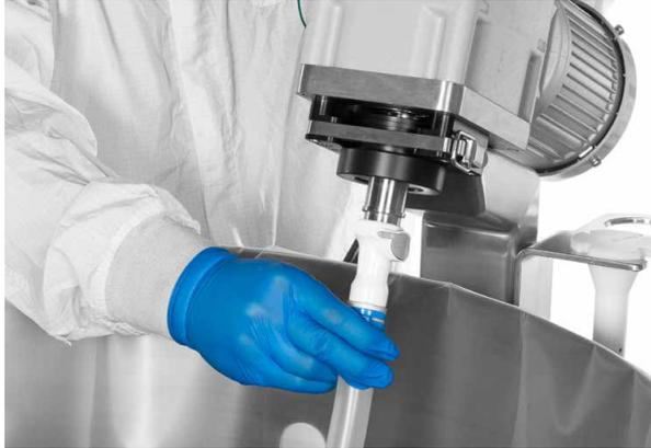
Abbildung 5.26. Anbringen der Propellerhülse.
