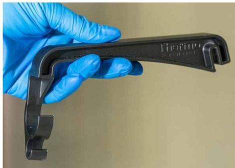
Abbildung 8.27. Kunststoff-Sondenklammer.
