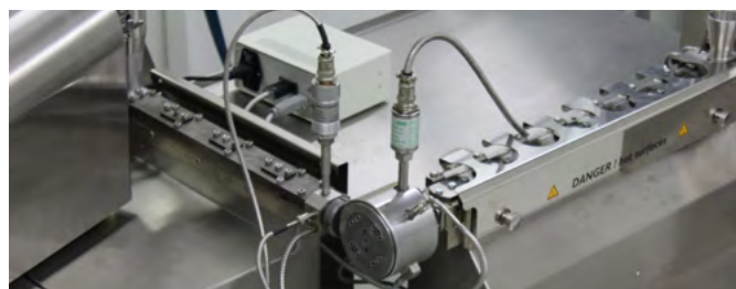
図1. 共押出用の二軸スクリーエクストルーダーの配置
