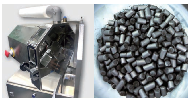
図6. FaceCut 16ペレタイザー (左) によりカットされた電極ペースト (右)
