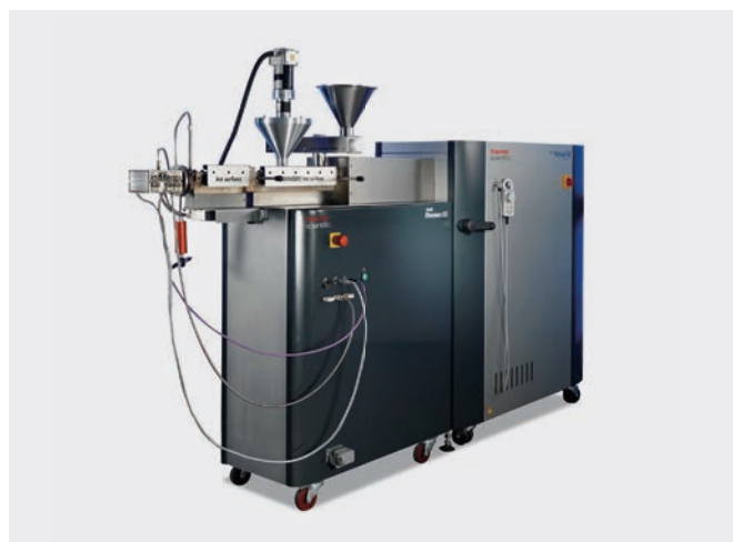
図5. HAAKE Rheomex PTW 16 OS二軸スクリーエクストルーダー (スクリー径16 mm)
