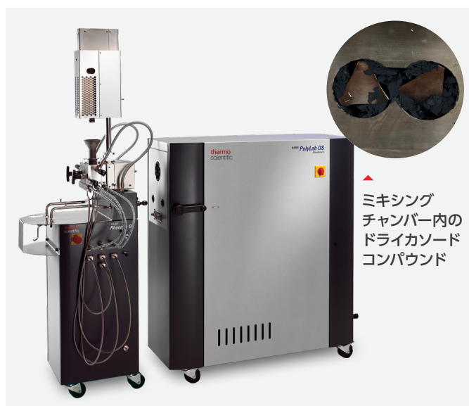
図4. Thermo Scientific™ HAAKE™ PolyLab™ OSドライブユニット (中央) に接続するThermo Scientific™ HAAKE™ Rheomix™ 600 ラボミキサー (左)
