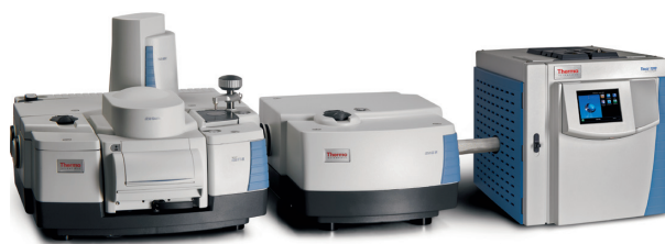
図4: Nicolet iS50 FT-IR + iS50 GC-IRモジュール + TRACE1310 GC
