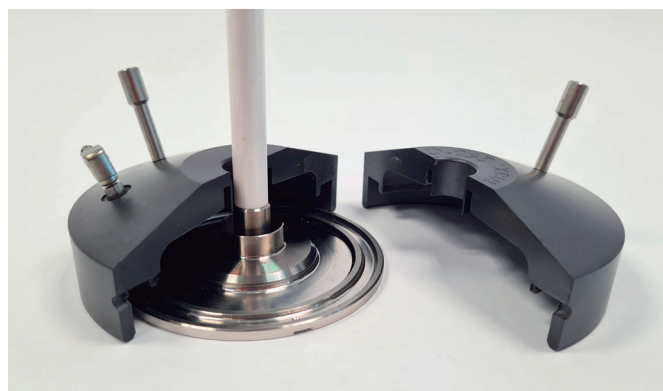
図1. PEEK製のサンプルフードは、温度勾配を最小にしたり、溶媒の蒸発を抑えたり、シールドガスでサンプルをフラッシュしたりするために使用
