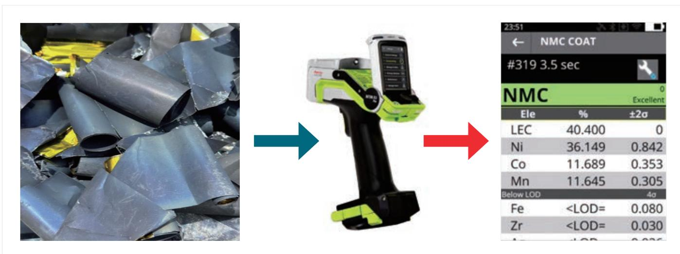
図1. HHXRFを使用してカソードスクラップフィルムの種類を識別し、生産スクラップを分類
