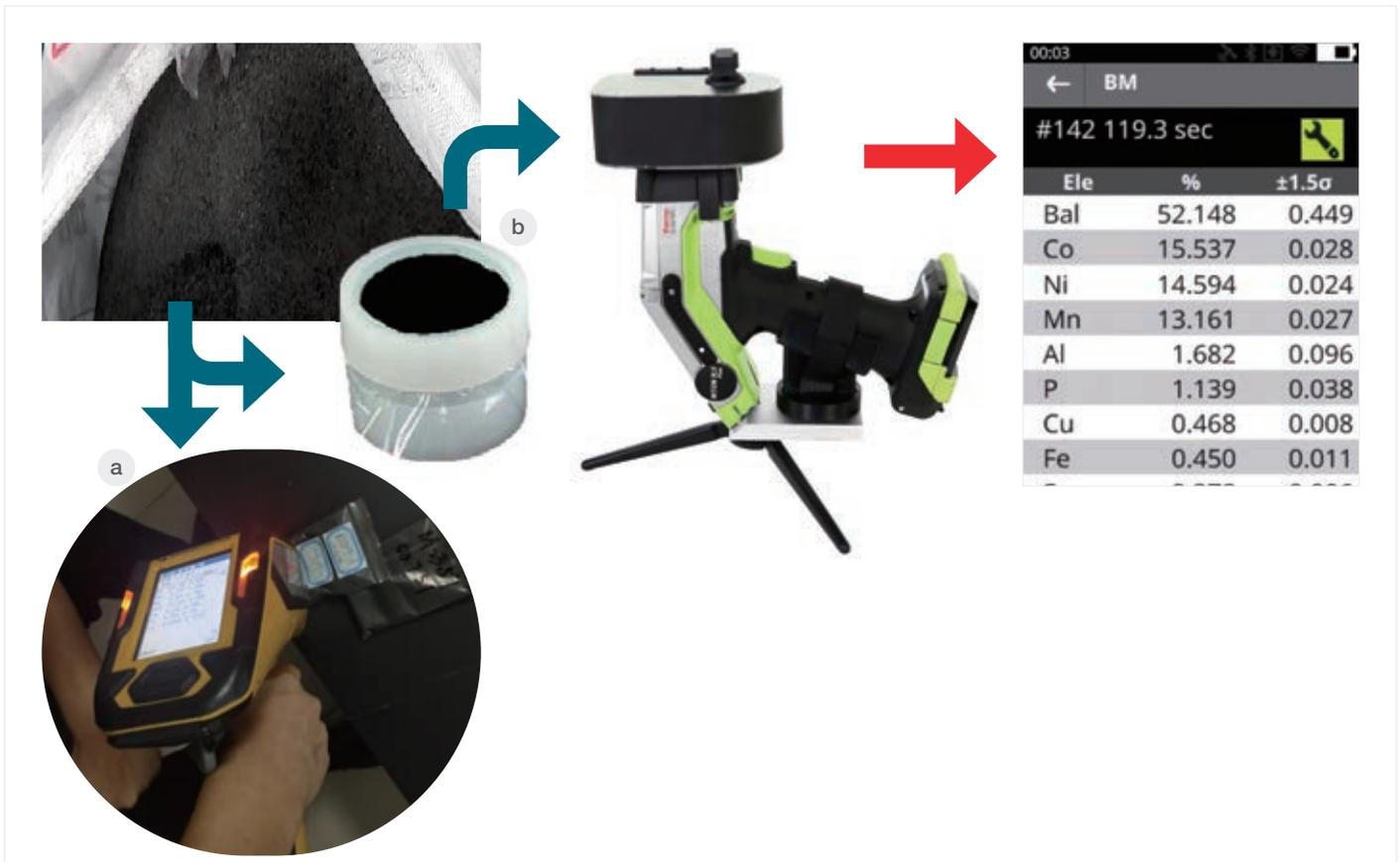
図2. ブラックマスの迅速な分析のワークフロー：(a) Niton XL2 XRF分析計を使用した袋内のブラックマスの半定量分析（銅、ニッケル、コバルト、マンガンなどのベースメタル）；(b) Niton XL5 Plus XRF分析計を使用したサンプルカップ内のMgからUまでの全元素範囲の定量分析
