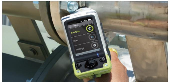
石油精製所のタイト溶接部を分析するために使用される Niton XL5 Plus
