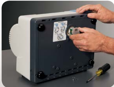
Remplacement de source infrarouge
