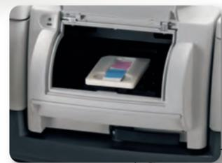
Untersuchung von Pulvern, Tabletten, Folien, Fasern und Partikeln
