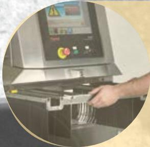
Cortinas de proteção contra Raio-X sem chumbo em estrutura totalmente ajustável e removível para obter segurança, flexibilidade e fácil manutenção.
