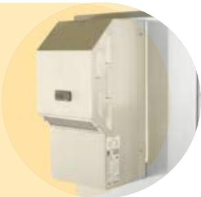
Opções de rejeição com jato de ar e impulsadores. Recipiente de rejeitos bloqueável com verificação de rejeitos e photoeyes (sensor fotoelétrico) para recipiente cheio também.
