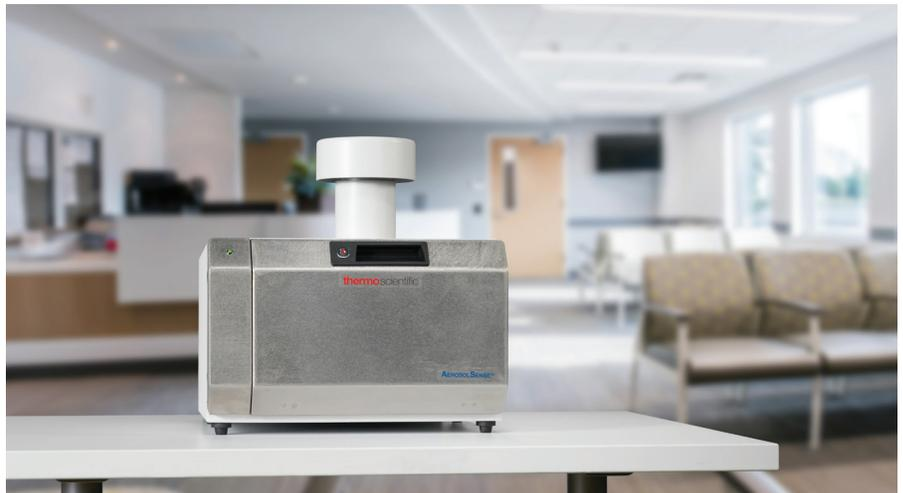
Aufgrund seines kleinen und unauffälligen Designs kann der AerosolSense Sampler in stark frequentierten Bereichen aufgestellt werden, um Luftproben zu nehmen, die Krankheitserreger enthalten können.
