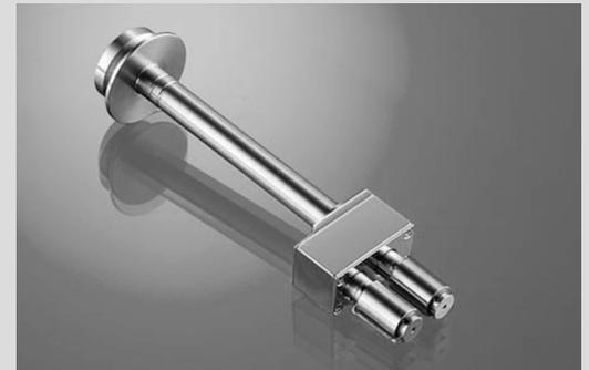
SER Tool für dehnreologische Messungen an einem Polymerfilm
