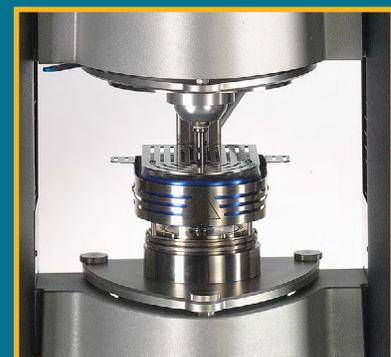
Elektrisches Temperiermodul für parallele Platten mit aktiver oberer Temperierung
