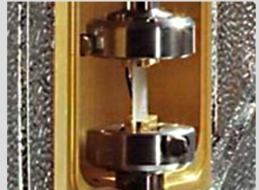
Festkörperklammern für DMTA Tests an einem Prüfkörper
