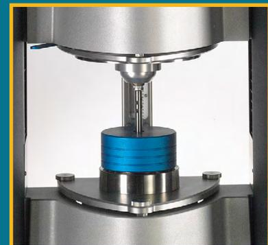
Temperiermodul für parallele Platten mit isolierter Proberaumabdeckung
