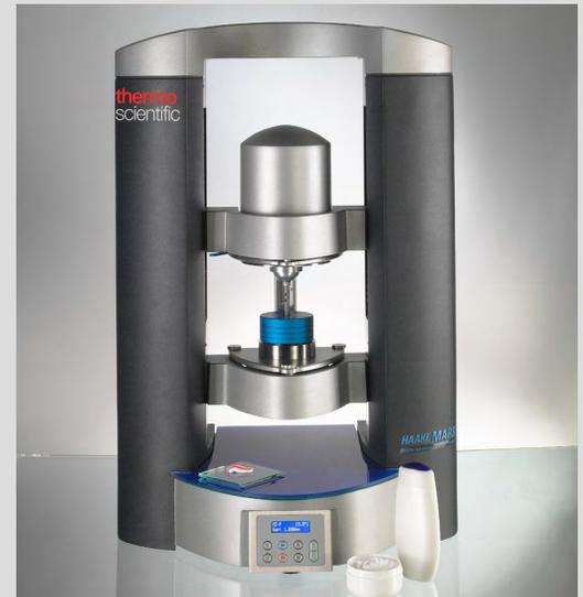
HAAKE MARS mit Peltier-Temperiermodul und isolierter Proberaumabdeckung TM-IN-H
