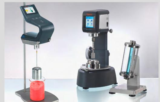
Kugelfallviskosimeter sowie eine Auswahl an Rotationsviskosimetern und -rheometern für die schnelle und zuverlässige Messung der Viskosität in der QS
