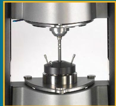
Temperiermodul für parallele Platten mit Proberaumabdeckung
