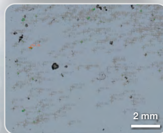
Siフィルター上のマイクロプラスチック粒子を解析
