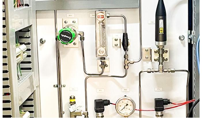
고체상 라만 분광 시스템인 Thermo Scientific™ MarqMetrix™ All-In-One Process Raman Analyzer는 움직이는 부품이 없기 때문에 인라인, 앳라인, 오프라인 및 일상적인 연구실 분석을 포함한 지속적인 프로세스 모니터링에 최적화되어 있습니다.
