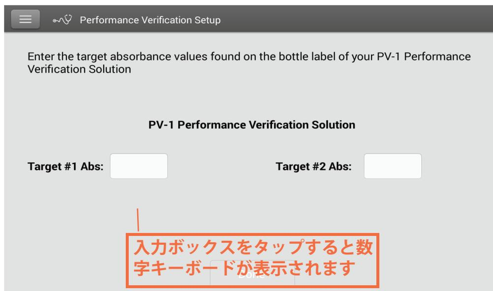
2. PV-1 アンプルのラベルに記載されている各ロット固有のターゲット吸光度値を、それぞれの入力ボックスに入力し、[完了]をタップします。
