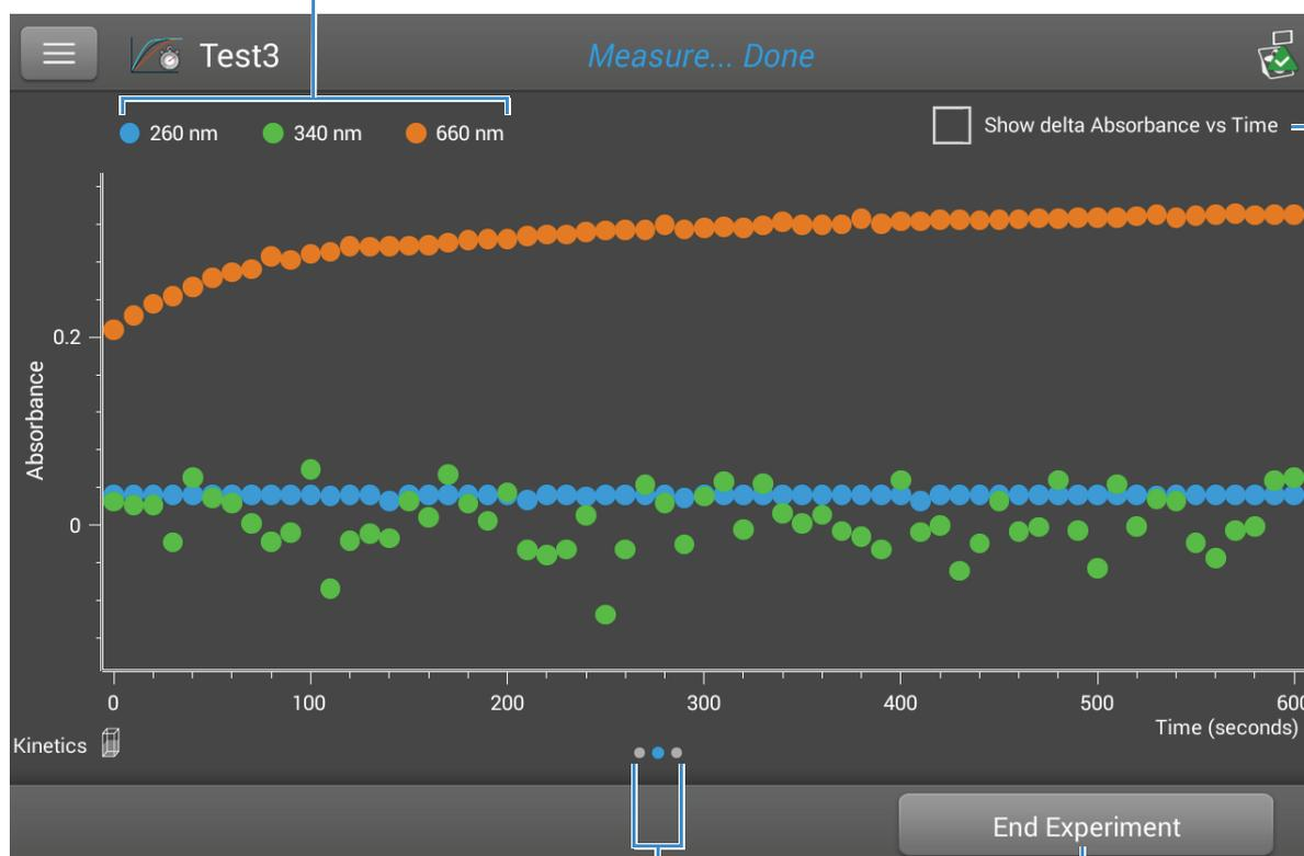
タップしてプロットを更新し、吸光度測定値の経時変化を示します(下の例を参照)。
