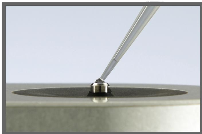
6. 1  $\mu\text{L}$  の脱イオン水をピペットで取り、下側の台座にアプライします。
