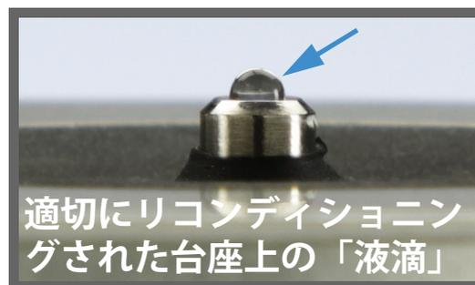
**ヒント** PR-1 リコンディショニングコンパウンドは、台座をリコンディショニングする最も容易な方法です。PR-1 キットが手元がない場合は、以下の手順に従ってください。
