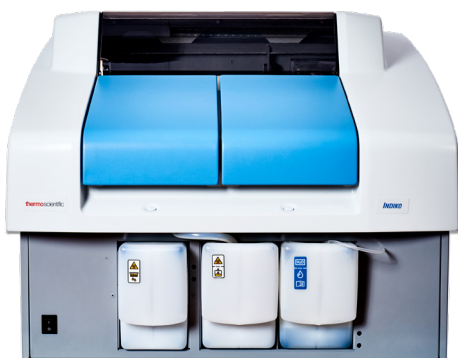
Анализатор Indiko до 200 фотометрических тестов в час
