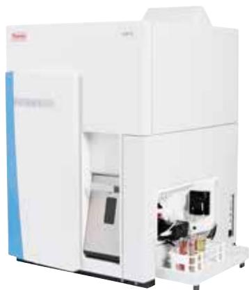
另外，采用高分辨率技术（High Resolution），可以进一步衰减高含量元素灵敏度，软件中只需点击设置即可使用。采用CCT技术不仅可以去除干扰，同时也可以有效降低轻质量元素灵敏度，因此也可以作为饮用水中高含量分析的模式选择。
