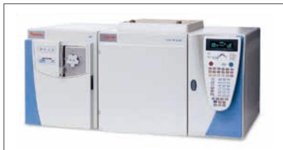
图4-11 ISQ单四级杆气相色谱质谱联用仪
