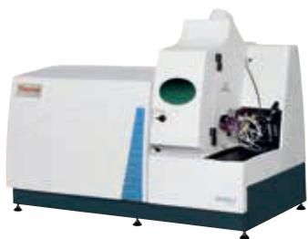
ICP-MS具有无机元素分析仪器中最宽的线性动态范围，一般可达8~9个数量级的线性。
