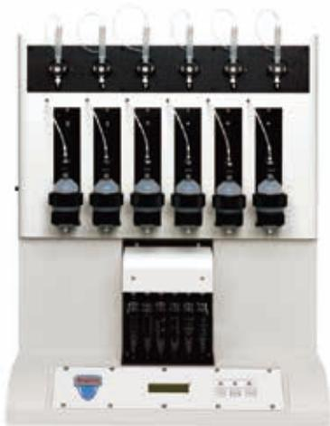
图3-1 进行自动SPE的AutoTrace仪器
