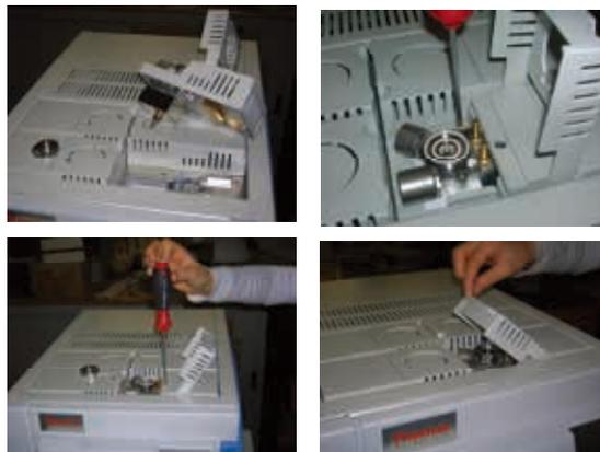
图4-4 快速更换进样口示意图
