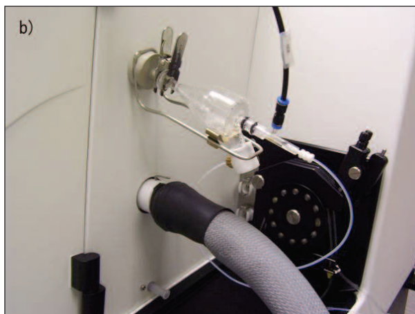
図2 GC-ICP-MSのデュアルモード試料導入 a) デュアルモードICPトーチ b) GCトランスファーラインと内部標準溶液の接続
