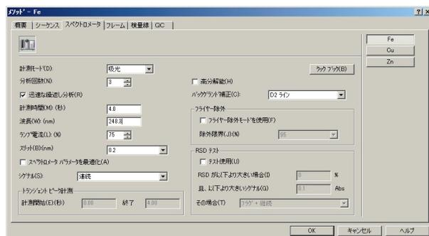
図1: 鉄のフレームパラメーター設定の例
