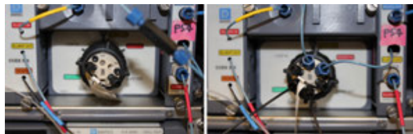
図6. ICキューブインジェクションバルブのポート1とポート4に取り付けられたDionex IonSwift濃縮カラム
