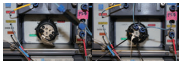
図 6. ICキューブの6方バルブのポート1と4に取り付けられたDionex IonSwift 濃縮カラム
