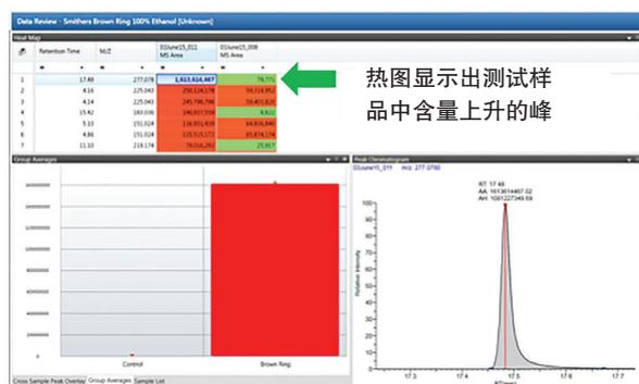
图 4. TraceFinder 中未知物筛查界面，其中展示了部分棕色环型密封圈样品 (B) 与空白样品 (对照) 比较的峰列表。热图 (窗口上半部分) 区别展示测试样品中含量显著提高的峰。分组平均化窗口 (窗口下半部分右侧) 展示了两个样品中保留时间为 17.49 min、基峰为  $m/z$  277.078 的提取离子流色谱峰。
