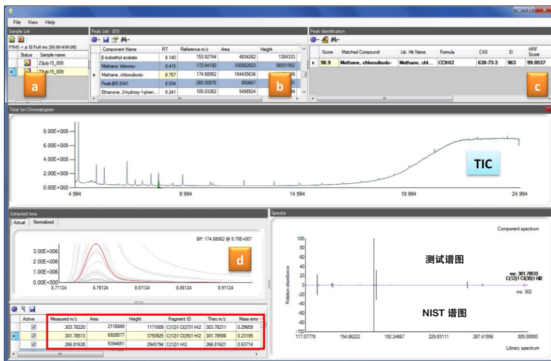
图 3. 二氯碘甲烷鉴定的解卷积结果界面，化合物鉴定基于标准谱库 (NIST) 正匹配搜索指标 (SI 963)、碎片离子合理化评价 \text{HRF} > 99\% 和测试碎片离子的质量精度 (例如，分子离子 m/z 301.78513 质量偏差 = 0.23 ppm) 进行。样品处理 (a)、峰检测 (b)、鉴定化合物 (c) 和标明测试离子和理论离子及相关质量数偏差的二氯碘甲烷的解卷积质谱图 (d)。
