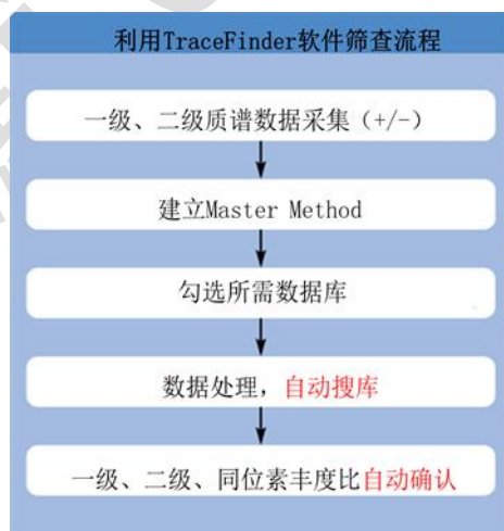
图 6 利用 TraceFinder 进行大规模兽药筛查流程
