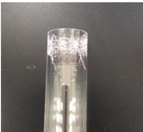
有机物对石英炬管可能造成的晶化现象
