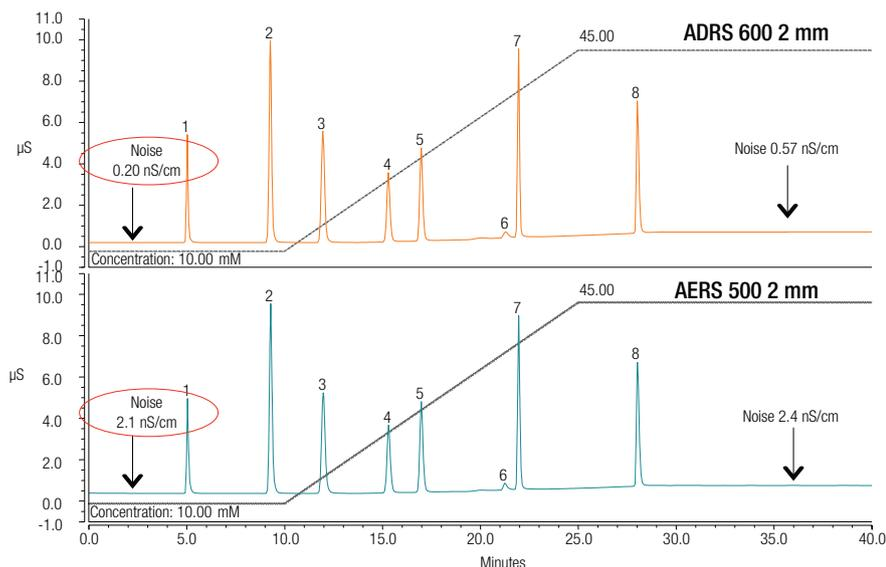
Column: Thermo Scientific™ Dionex™ IonPac™ AS19-4µm 2 mm
