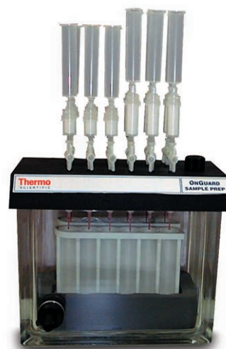
図4：Dionex OnGuard 試料前処理ステーション
