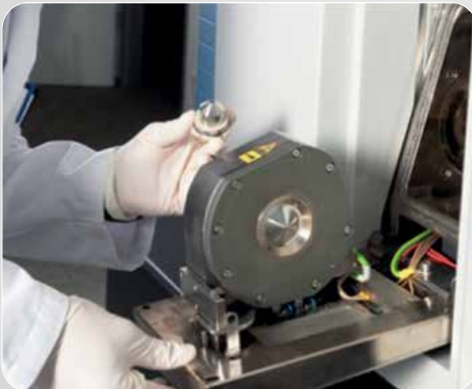
Abbildung 6. Leicht zugängliche Konen durch einzigartiges Drop-Down Interface
