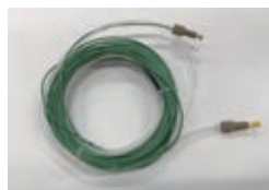
サンプル移送用 配管+フィッティング
