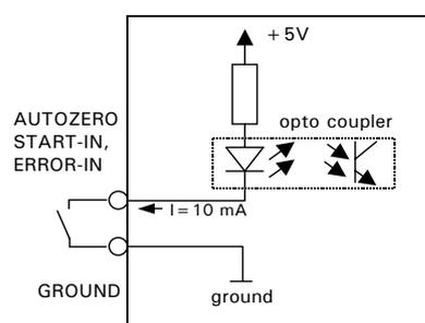
FIGURE 5-8. Input Circuits
