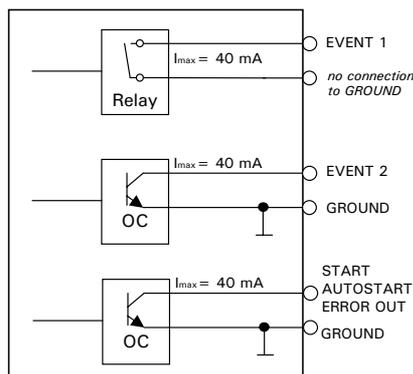
FIGURE 5-7. Output Circuits
